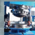
Ruedas manipuladoras con revestimiento vulcanizado y motorización hidráulica.
