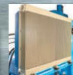
Sistema de refrigeración de fluido hidráulico
