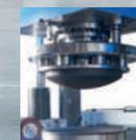
Cilindro hidráulico con doble columna guía
