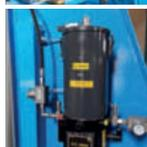
Sistema automatizado de lubricación centralizada con temporizador y distribuidores monitoreados
