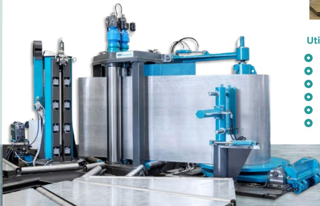
Utilizado para la producción de Silos de diámetros grandes compuestos por:
