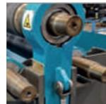
Accesorio de ejes extendidos para doblar secciones.
